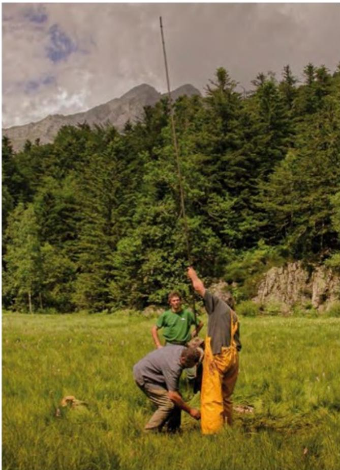
Opération de carottage manuel à l'aide d'une sonde « russe » sur la tourbière de Piet. Cette technique de forage permet de prélever des épaisseurs parfois considérables de sédiments sans perturber leur positionnement stratigraphique (photo Didier Galop)
